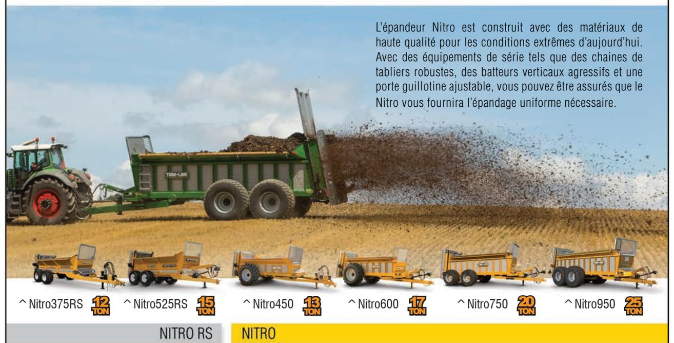
L'épandeur Nitro est construit avec des matériaux de haute qualité pour les conditions extrêmes d'aujourd'hui. Avec des équipements de série tels que des chaînes de tabliers robustes, des batteurs verticaux agressifs et une porte guillotine ajustable, vous pouvez être assurés que le Nitro vous fournira l'épandage uniforme nécessaire.
